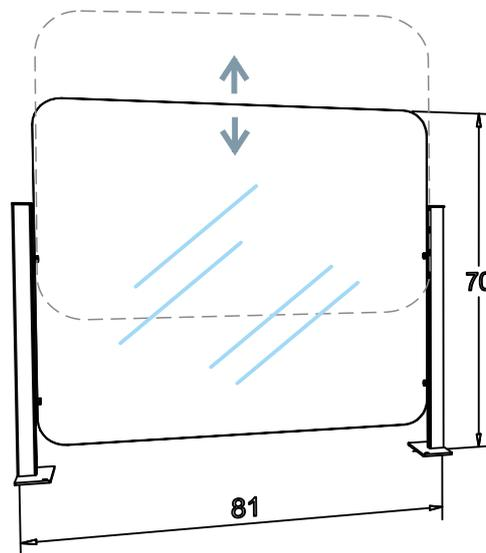
Oltre alla soluzione fissata sul piano scrivania con morsetto che accoglie piani da cm 1.8 a 3.3, esiste anche una soluzione mobile con schermo autoportante con basi in lamiera cm 12x6 spessore 3mm dotate di due fori per eventuale fissaggio al top della scrivania.
